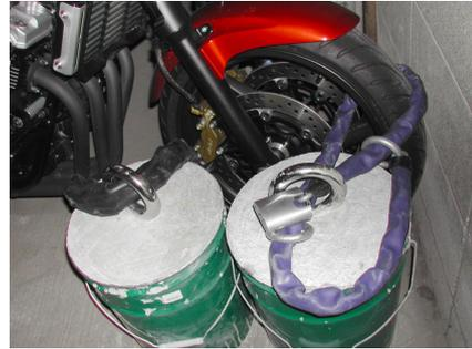
ホームセンターで「缶」「セメント」「砂」強度&重さを増やすための「石」、アンカーを固定するための「金網」を購入。（総額で3,000~4,000円位です）上の材料で作ったのが「手作りアンカー」です。1つの重さ約45kg、2つで合わせて約90kgあり、かなり重いです。
